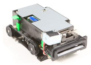
Lettore motorizzato ibrido per cart a banda magnetica, chip e contactless
